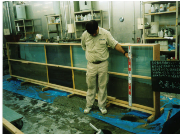
写真2 型枠充填性試験
