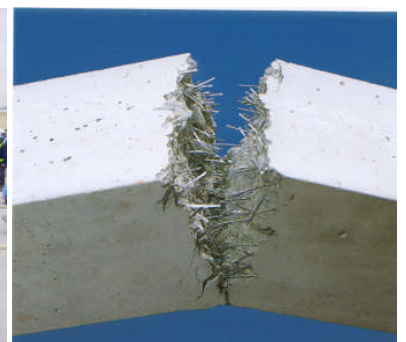
写真 3 曲げ試験体の破壊状況
